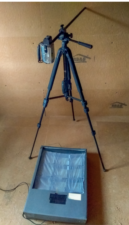
▼ Figuur 2. Opstelling van de testarena in een doos met doorzichtig deksel. Het verticale houten stokje (barrière) verhinderde de vleermuis om meteen het doolhof in te gaan en werd verwijderd aan het begin van de test. Boven de testarena hing een nachtzichtcamera om het ruimtelijk gedrag van de vleermuizen vast te leggen. Links onderin is de kabel van de microfoon die zich in de doos bevond te zien. © Lysanne Snijders
